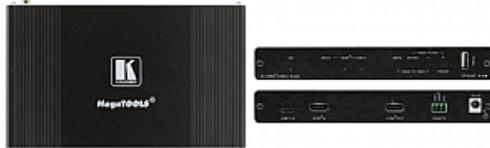
VP-424C ist ein leistungsstarker digitaler Scaler für HDMI- und USB-Signale vom Typ C. Das Gerät skaliert das ausgewählte Videosignal auf Auflösungen bis zu 4K@60Hz (4:4:4) bei einer maximalen Datenrate von 18Gbps (6Gbps pro Grafikkanal). Der Benutzer wählt den HDMI- oder USB-Eingang vom Typ C und der skalierte Ausgang wird an den HDMI-Ausgang gesendet
